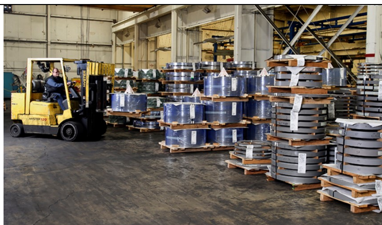
ورقه های فولاد الکتریکی تولید شده در کارخانه سازنده این مواد جهت ساخت هسته ماشینهای الکتریکی
